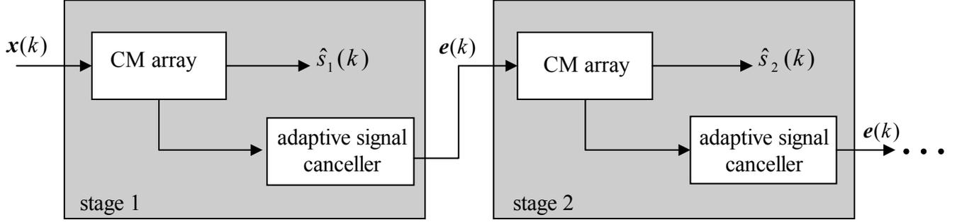
Fig. 1 the cascade multistage CM array
