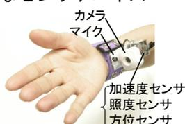
図2：実装したプロトタイプデバイス
