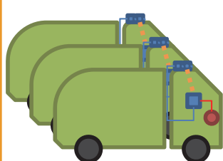
センサノード搭載ゴミ収集車
