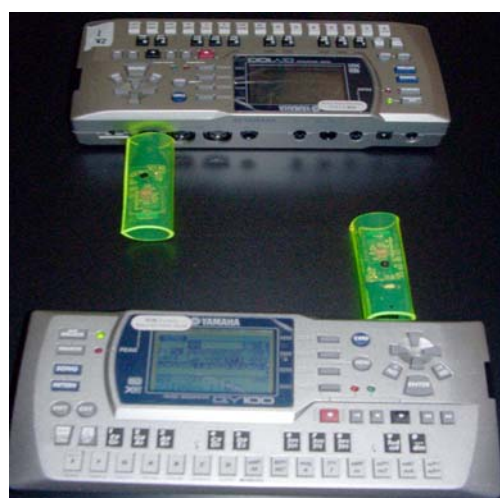
図 1: 試作した Bluetooth-Midi Adapter
