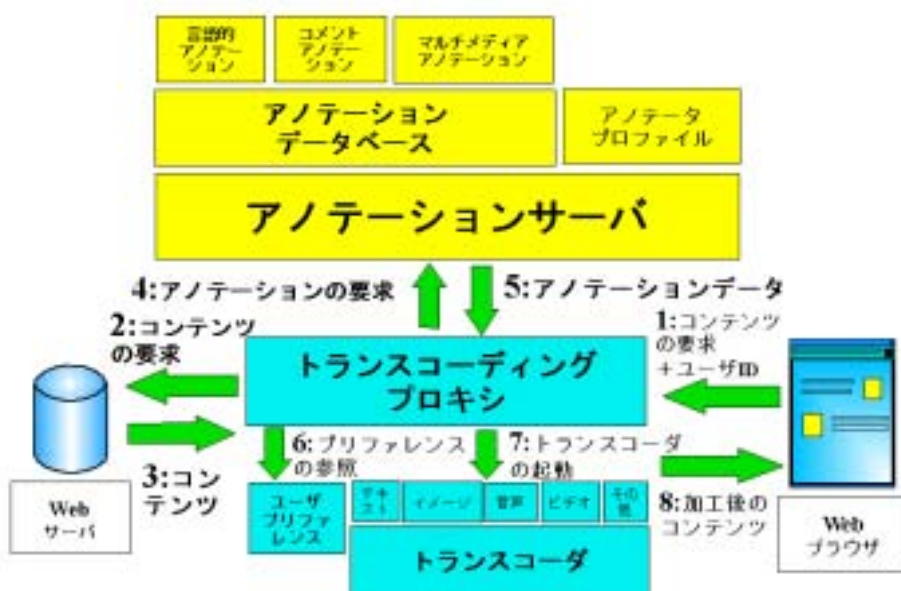
図 2 セマンティック・トランスコーディングシステムの構成
