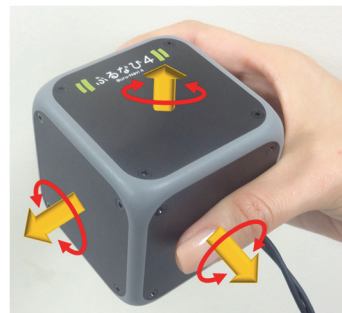
6自由度型ぶるなび (Cubic force 6D)
