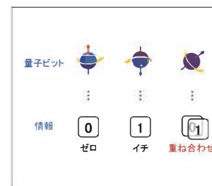
図1:電子スピン(ある軸についての回転)の向きを 利用した量子ビット
